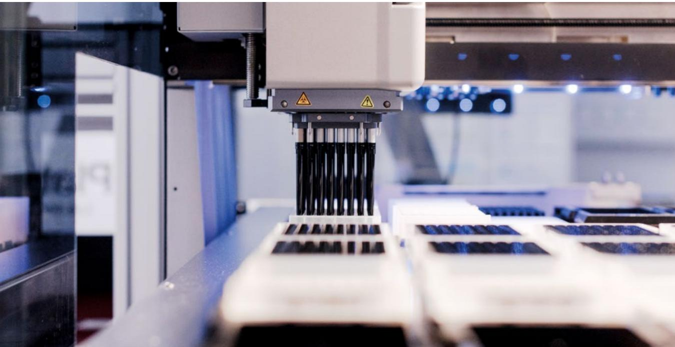
Mit Hilfe von Roboteranlagen lassen sich 10.000 Tests parallel durchführen – die langwierige händische Suche nach dem geeigneten Molekül ist passé
